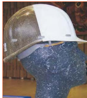
Čelada na sliki je ojačena z bombažem in lanom (Schubert Helmets), tehta 265 g in ustreza standardu DIN EN 397 za zaščitne čelade. Je lažja od tiste, ojačene s steklom, toda s 5 % višjo ceno.
